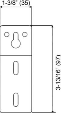
\*\*\*Soporte de Montaje de la Cubierta de Conductos
