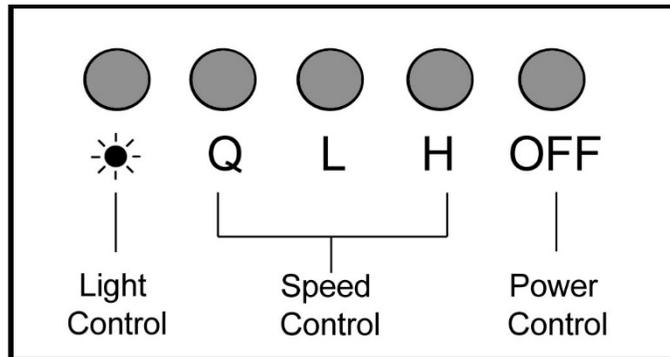
Nota: Para obtener los mejores resultados, encienda el ventilador antes de cualquier preparación o cocina y mantenga los ventiladores encendidos mientras usted cocine. Ajuste la velocidad según sea necesario.
