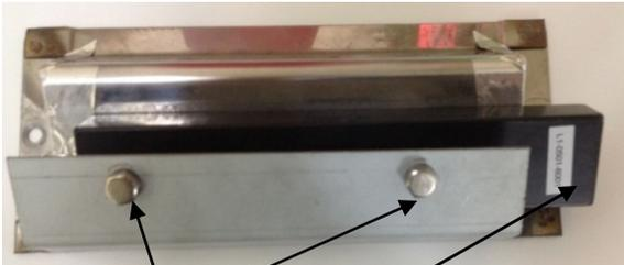
开关的固定螺丝 开关没接线
